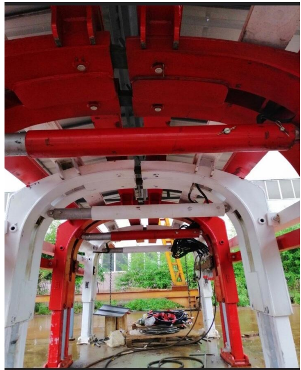
Hình 1. Tổ hợp giàn chống thủy lực di động hình vòm.
